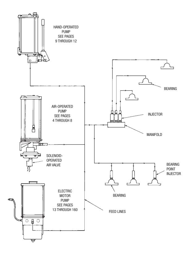
Figure 1. LubriSystem Diagram
